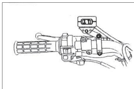
Рис.4. Размещение органов управления на руле. Точное расположение зависит от конкретной модели вездехода.
