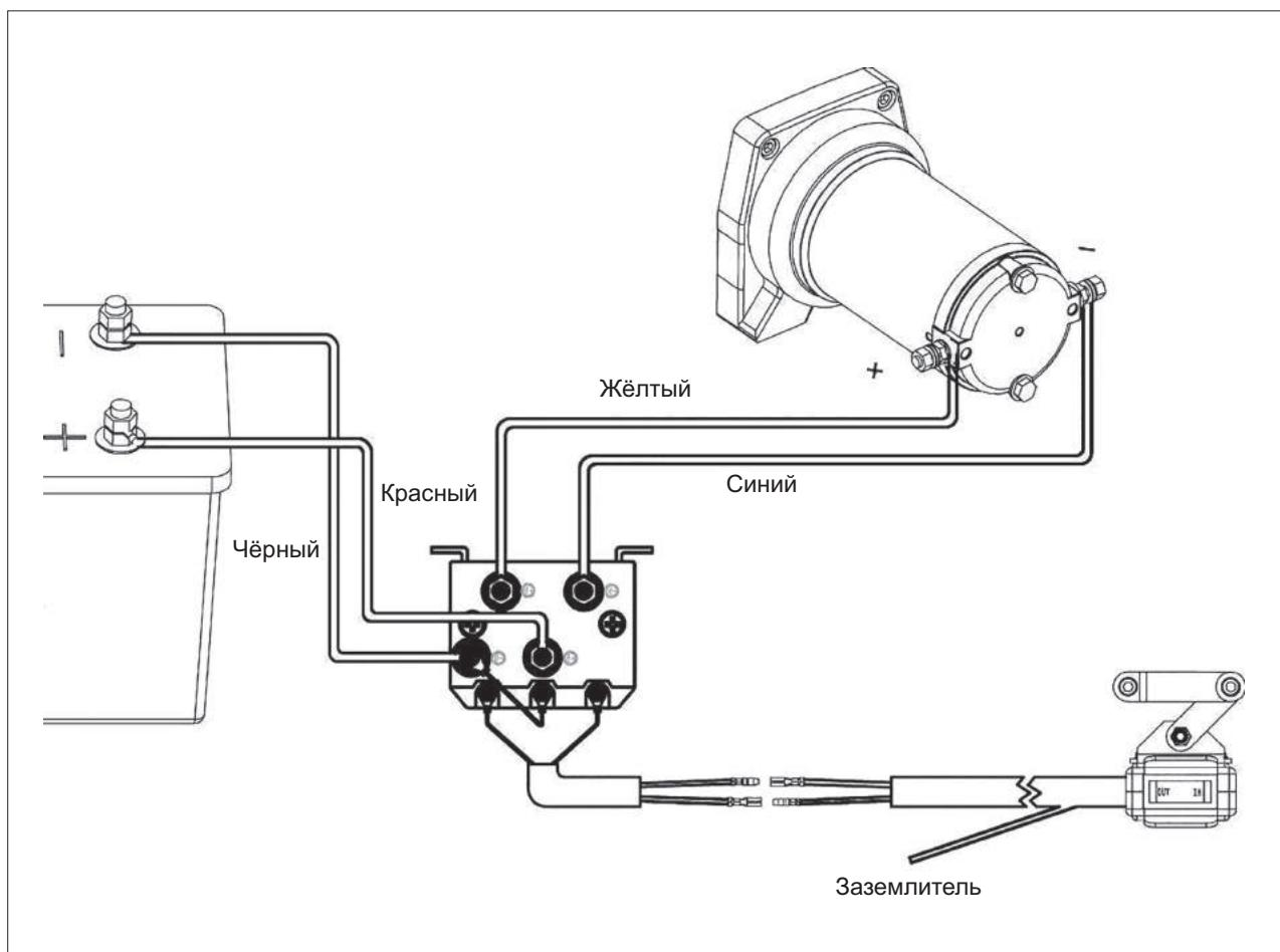
Рис. 7. Принципиальная электрическая схема подключения
