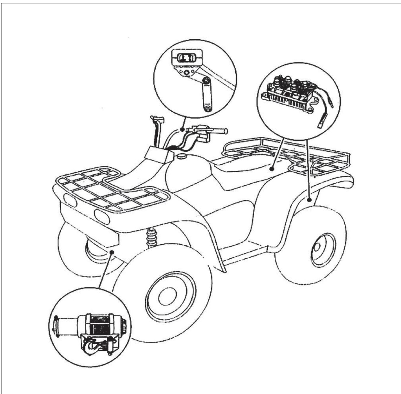
Рис.1. При установке полного комплекта вам необходимо смонтировать лебёдку, контактор и возвратный мини-переключатель на руле. Размещение компонентов зависит от конструкции мотовездехода. Для правильного выбора их расположения прочтите данное руководство и выполните его инструкции.
