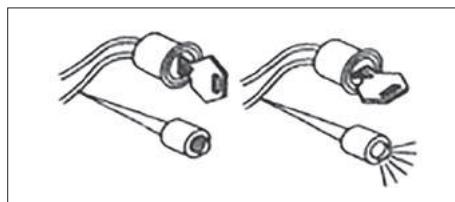
Рис. 6. Использование индикаторной лампы при определении полярности
